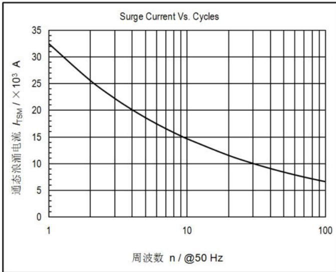
图7. 通态浪涌电流与周波数的关系曲线
